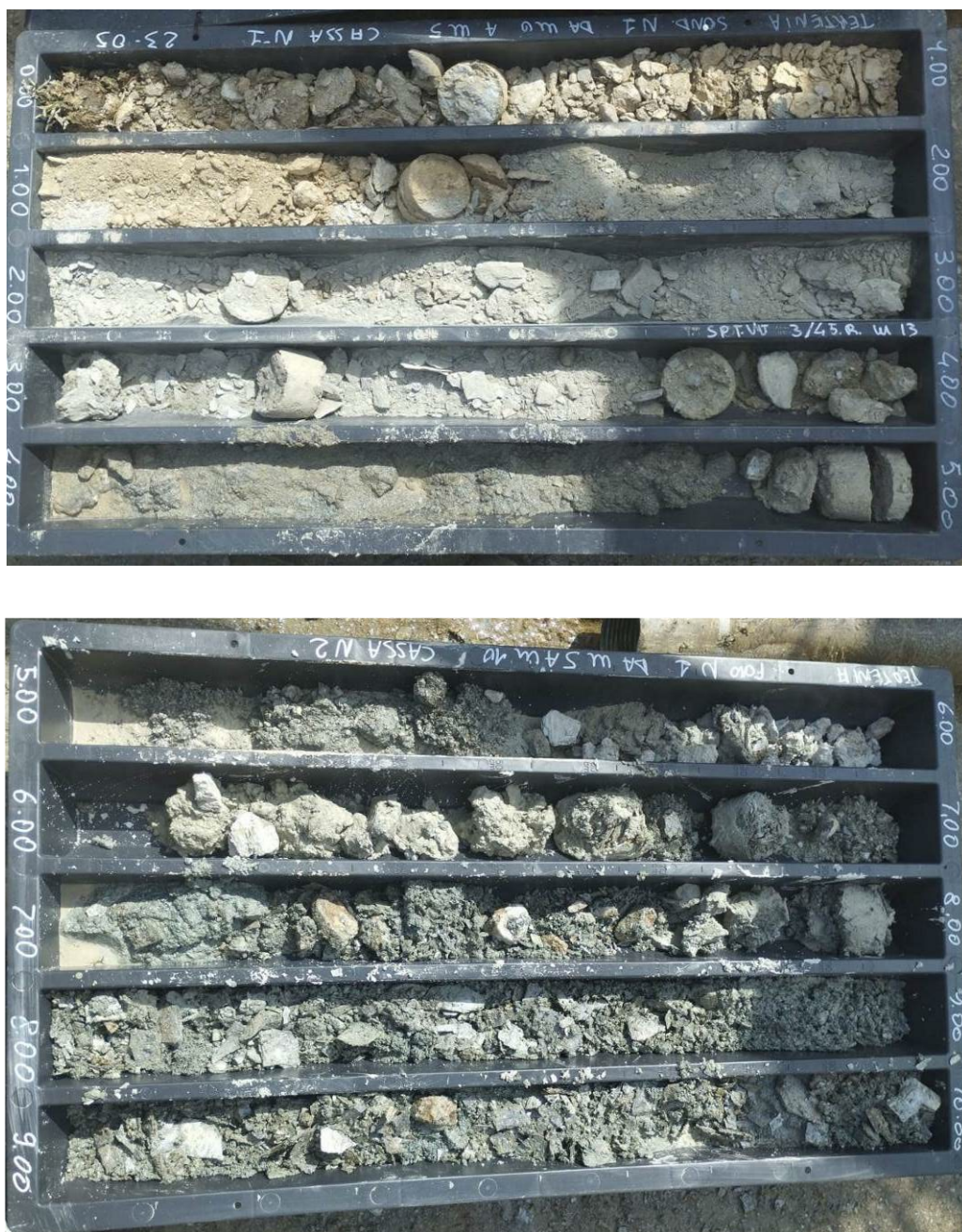
Figura 4 – Materiali estratti dal sondaggio n. S 1
